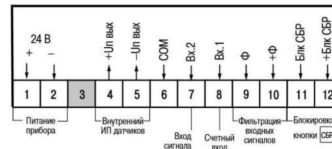
Рисунок 5.1 – Назначение контактов клеммника
